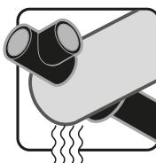
2. Calentar la memoria simultánea el tubo y la conexión hasta la marca\* en sus respectivos datos, sujetando ambos en forma perpendicular a la barra de calentamiento de la Termofusora. En ese punto deberá tomarse los tiempos mínimos de calentamiento (ver tabla 1).
